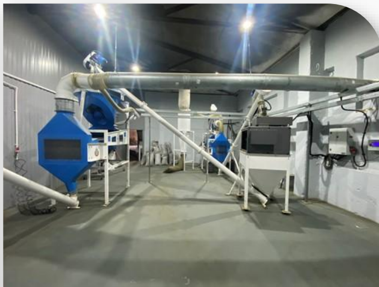
очистка и сепарация (отделение лузги) подсолнечника
